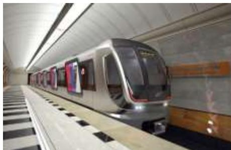
**Метрополитен**, или метро, скоростной местный пассажирский железнодорожный транспорт, линии которого полностью или частично проложены в туннелях. Благодаря отсутствию пересечений на одном уровне поезда метрополитена могут ходить с повышенной скоростью. В центральной части города линии метро прокладываются под землей, а в других районах – также в открытых выемках, на поверхности или на эстакадах.
